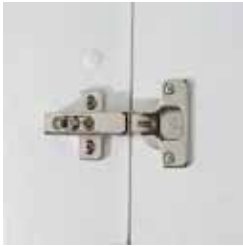
Volledig metalen scharnier, 3D verstelbaar, 35 mm scharnierboring
